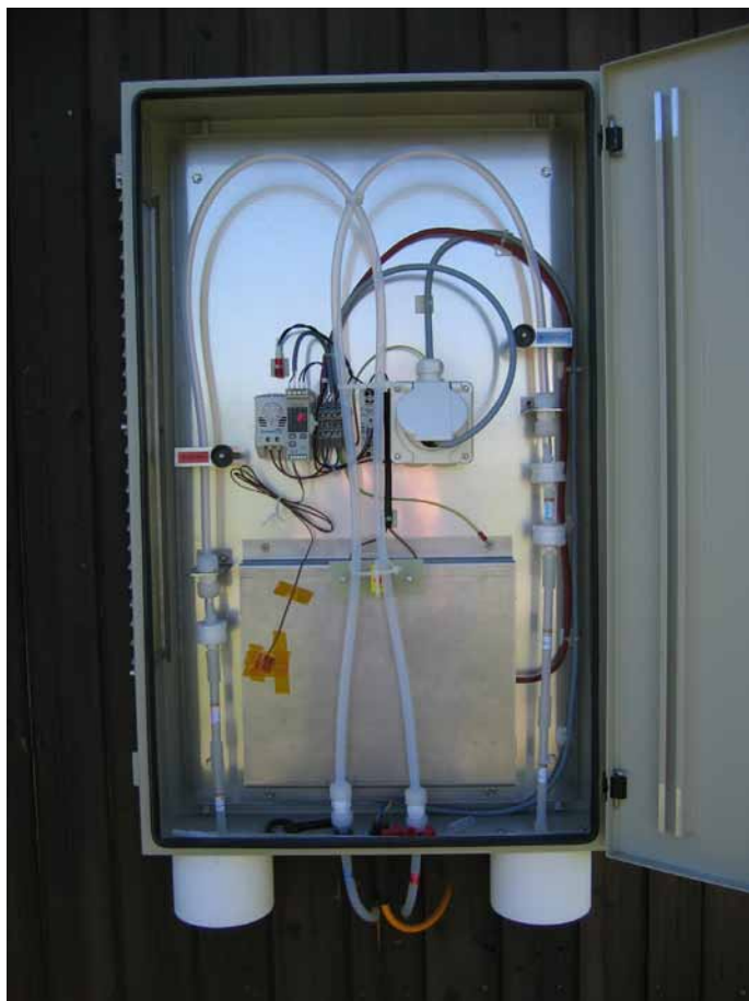
Abb. 3-33: Probenahme Mini-Denuder-System (MD-System)
