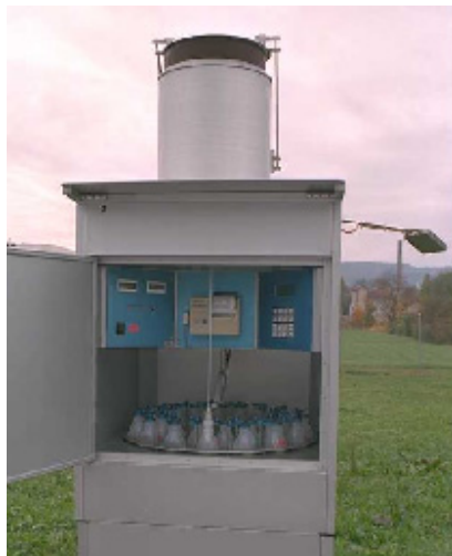
Abb. 3-26: Probenahme mit Regensammler
