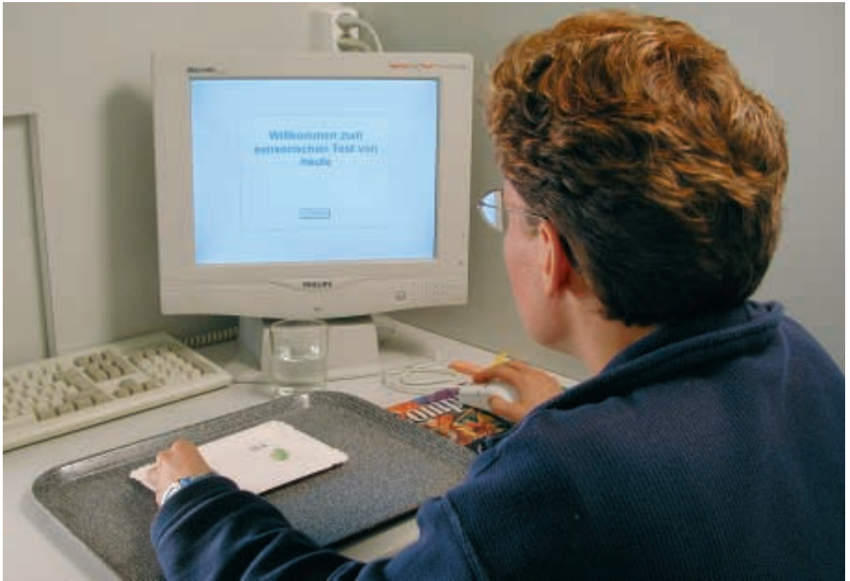
Abb. 1: Typische Anordnung für sensorische Tests. Jede Prüfperson einer Prüfergruppe sitzt in einer Boxe, erhält die Proben durch eine Öffnung vorgesetzt und gibt ihre Beobachtung in ein vorgegebenes Antwortschema im Computer ein.
