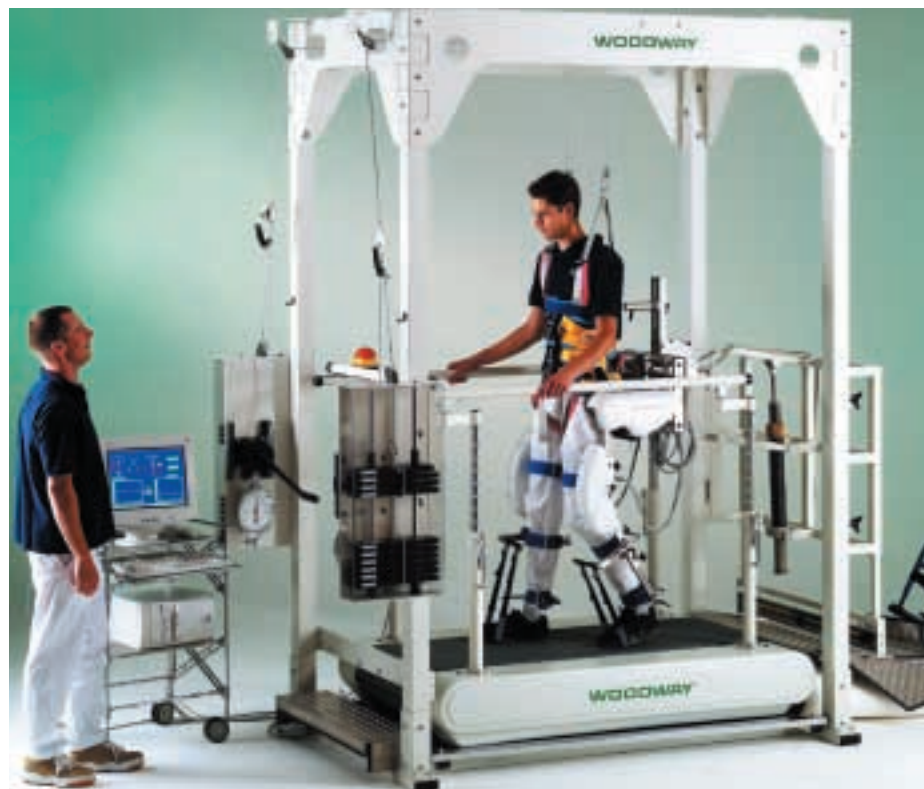
Abb. 3: Der Lokomat wurde speziell dazu entwickelt, das Laufbandtraining für Querschnittgelähmte und Hirn Schlagpatienten zu automatisieren.
