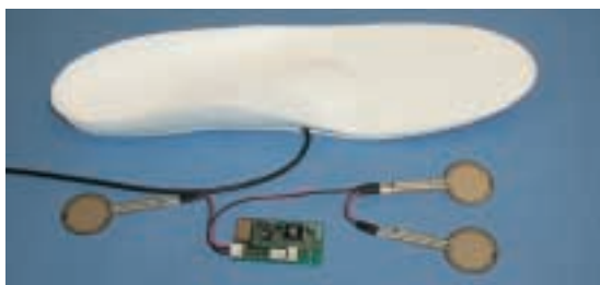
Abb. 1: Zur automatischen Detektion der Gangphasen wurde eine «intelligente» Schuhsohle mit integriertem Mikrocontroller, Drucksensoren (FSR = Force Sensitive Resistor) und einem Winkelgeschwindigkeitsmesser (Gyroskop) entwickelt.
