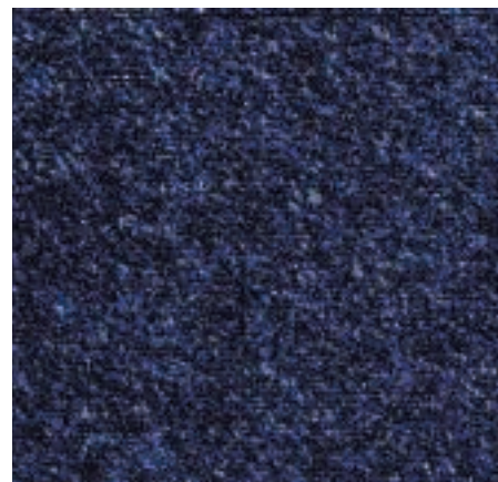
Abb. 1: Affymetrix GeneChip™, auf dem sich 12'000 menschliche Genproben befinden. Die weissen Punkte zeigen hoch aktive Gene, die dunkleren Punkte wenig aktive.
