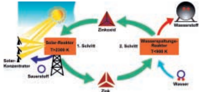
Abb. 2: Zweistufiger thermochemischer Zyklus für die solare Herstellung von Wasserstoff aus Wasser.
