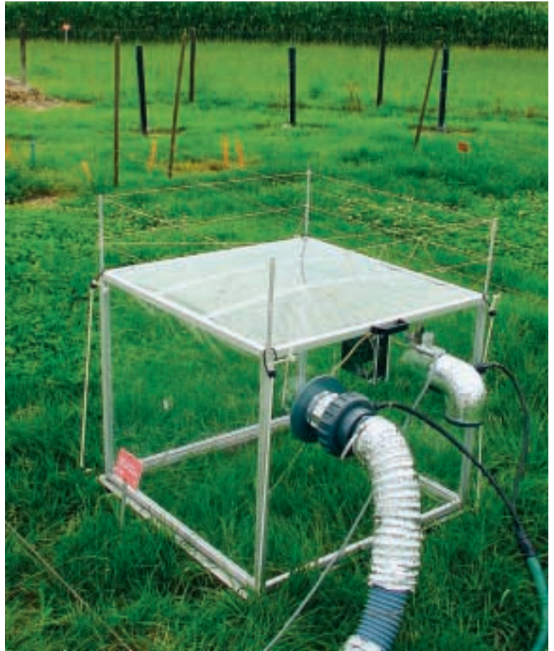
Abb. 2: Transparente Kammern werden verwendet, um den Netto-CO 2 -Austausch des Ökosystems zu messen.
