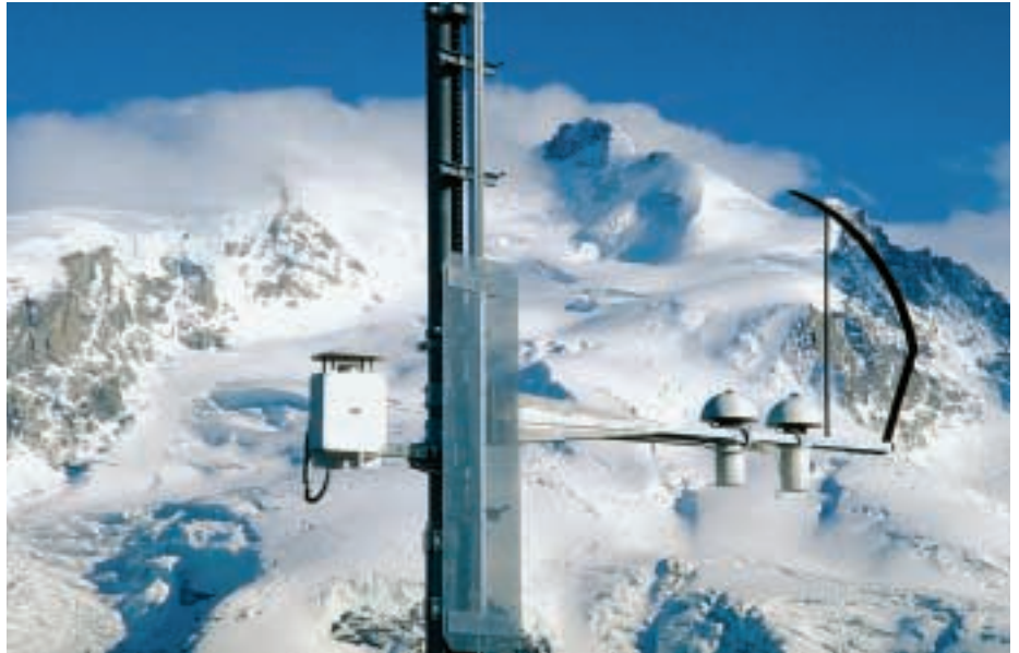
Abb. 2: ASRB-Station Gornergrat mit Instrumenten zur Messung der Sonnen- und Wärmeeinstrahlung rechts auf dem Aushänger, mit Schattenband im Süden. Links Temperatur- und Feuchtesensor «Thygan» der MeteoSchweiz.
