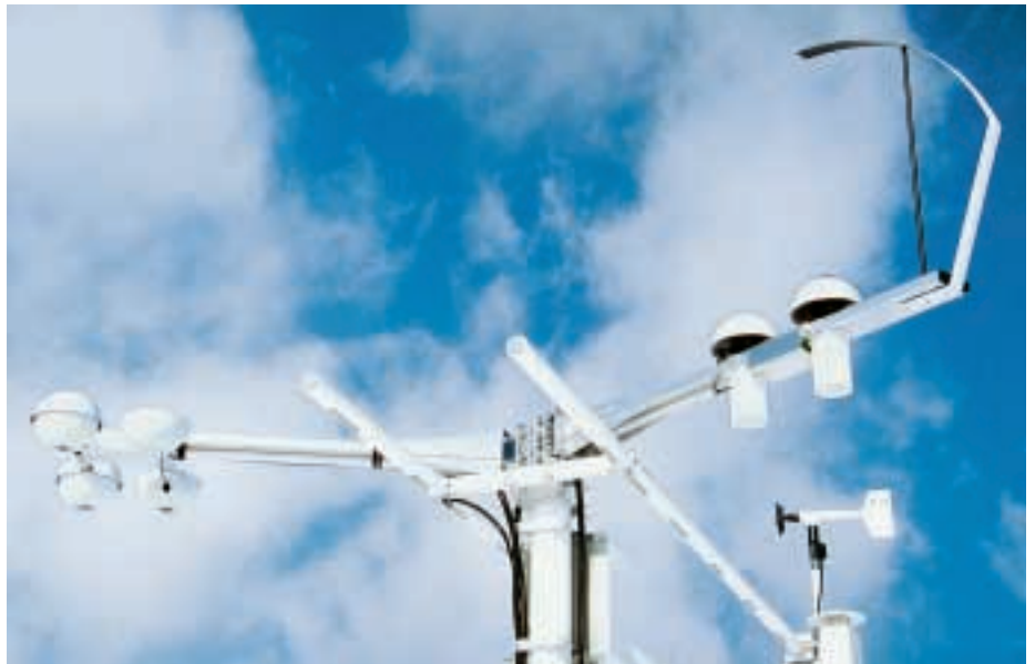
Abb. 3: Station im Versuchsfeld des Schnee- und Lawinenforschungsinstitutes auf dem Weissfluhjoch mit Instrumenten rechts vorne zur Messung der kurzwelligigen Sonnen- und der langwelligigen Wärmeeinstrahlung sowie Instrumente ganz links zur Messung der reflektierten Sonnen- und vom Boden emittierten Wärmestrahlung.
