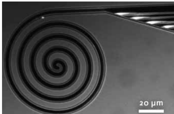
Abb. 1 bis Abb. 4: Mikroskopische Bahnen: In offenen Kanälen werden die fluoreszierenden Nanotransporter sortiert und gelenkt.
