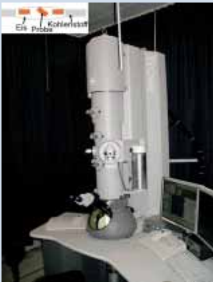
Abb. 1: BILD EINES HEUTIGEN ELEKTRONEN- MIKROSKOPES und eine schematische Darstellung, die zeigt, wie biologische Makromoleküle (orange) im amorphen Eis (weiss) abgebildet werden. Das Eis ist trägerfrei innerhalb eines Loches eines Kohleträgerfilmes (grau).
