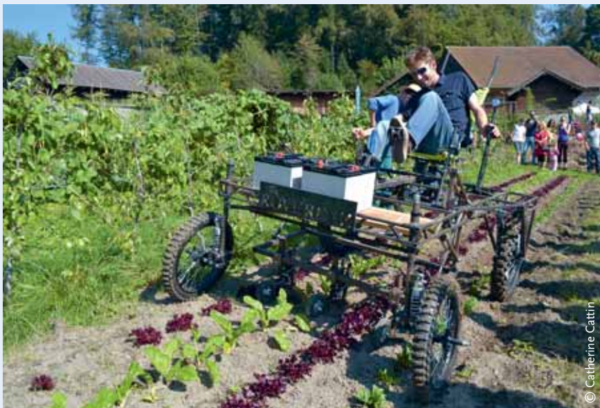
ABBILDUNG 1: Innovationen für die urbane Landwirtschaft: Der Fahrradtraktor „Aggrozouk“ kann zum Säen, Jäten oder Hacken verwendet werden. Er wurde auf der Domäne Rovéréaz mithilfe von Open-Source-Plänen günstig konstruiert.
