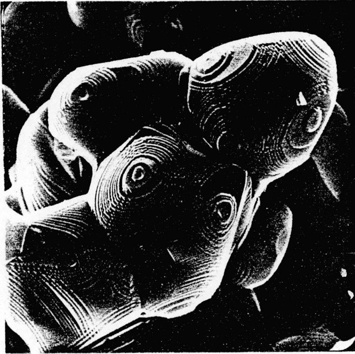
Fig. 56 Agglomeration kubischer Magnesiumoxid-Zinkoxid Mischkristalle ca. 8000-fach vergrößert.
