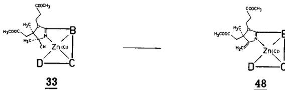
Eduktmaterial<sup>170</sup>, das UV/VIS-spektroskopisch bestimmt ( $\epsilon(521/\text{MeOH}) = 15\ 000$ ; vgl. 131))  $68\ \mu\text{Mol}$  ( $\hat{=} 71,8\ \text{mg}$ ) ABCD-Cyan-zinkkomplex 33 enthielt, wurde mit Benzol<sup>43</sup>) in einen 50 ml Rundkolben transferiert, das Benzol am RV abgesogen und der Rückstand über Nacht bei RT/0,01 Torr getrocknet<sup>103</sup>).
