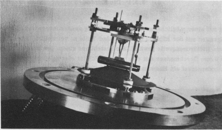
Fig. 3, 2 Das Strahlerzeugungssystem, montiert auf Testkammer-Flansch
