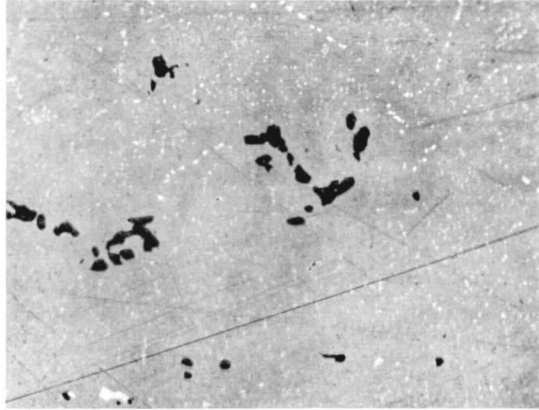
Abb. 10. Gewöhnlicher Zinnkies, körniges Aggregat, mit Zinnblende- (dunkel) und Kupferkiesentmischung (hell). Logrosán. Auflicht, 1 Nic., 350mal, Öl.
