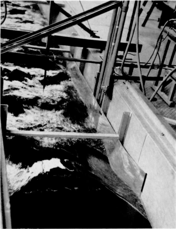
Bild 44. Fotografie der Strömung bei der Durchführung von Versuch 75 und 76. Die turbulente Strömung, insbesondere an der Wasseroberfläche, ist gut erkennbar. Der Stedhpegel konnte daher nicht benützt werden.
