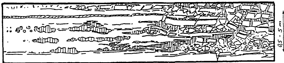
Fig. 57: Lösungsbrekzie Schichtparallele Brekzienvorkommen infolge der Lösung vom Sulfat
