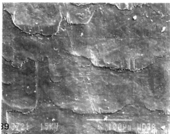
Bild 82, 83: REM-Aufnahme der "rillig sich kreuzenden" Oberfläche. \epsilon_v : 20%. \sigma_n : 25 N/mm 2 . Zwst: Pfinders SK255, v : 0.2 m/s, Kantenradius 10mm, Wz: GG25.
