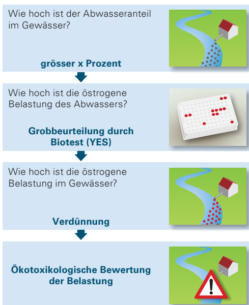
Abb. 4: Mögliches Vorgehen, um Gewässer hinsichtlich östrogen aktiver Substanzen zu beurteilen.
