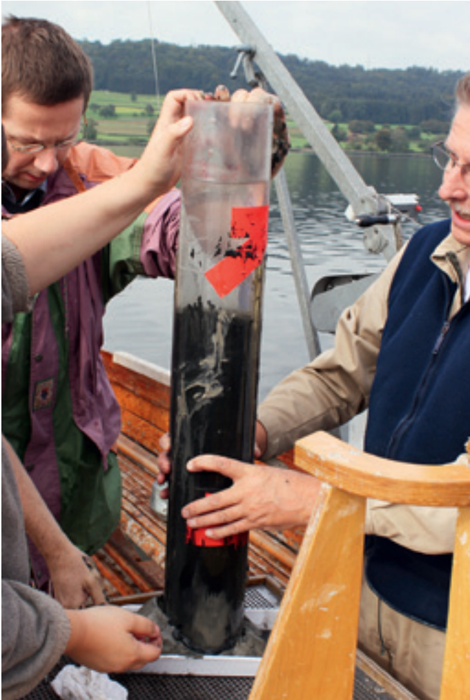
Bergung eines Sedimentbohrkerns aus dem Greifensee: Wie sich die Artenzusammensetzung bei Wasserflöhen in Abhängigkeit der Phosphorkonzentration im Lauf der Zeit veränderte, lässt sich mithilfe von Dauerstadien in den Sedimenten rekonstruieren.
