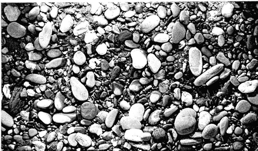
Abbildung 2.30 *Draufsicht einer Sohle, die innerlich kolmatiert ist. Versuch SR6.*
