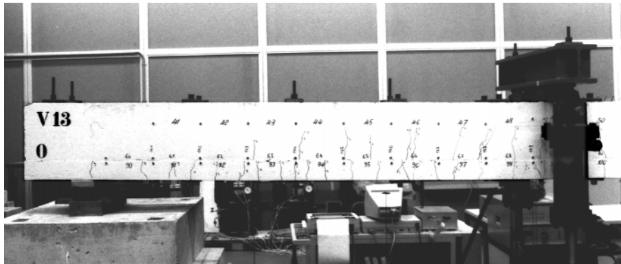
Fig. 3.6 Propagazione delle fessure nel corpo di prova D_{1s}
