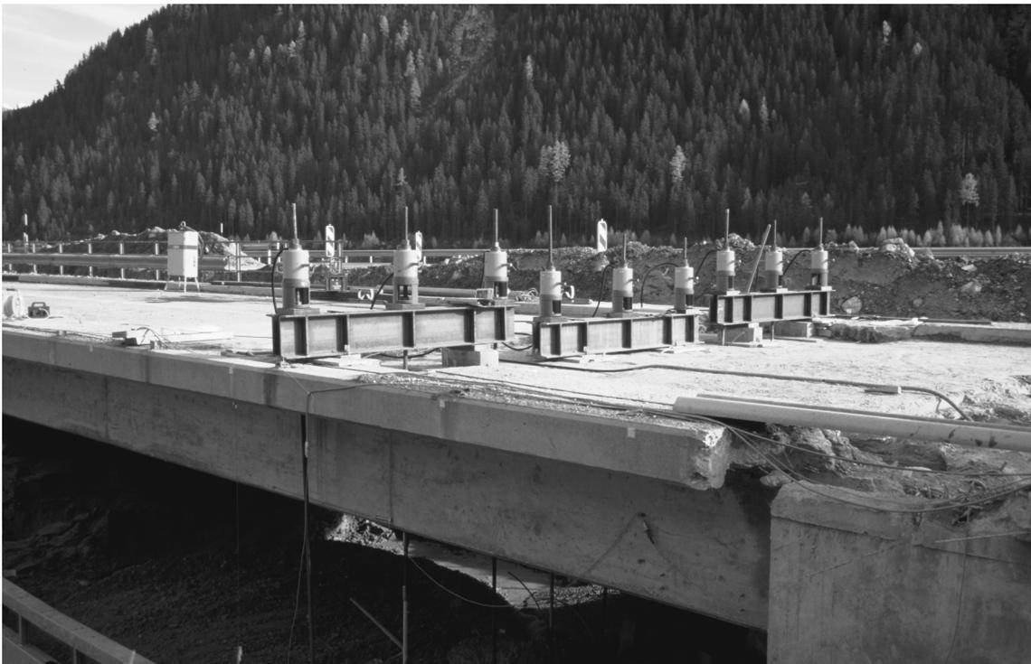
Bild 3.3 Belastungseinrichtung während des Bruchversuchs
