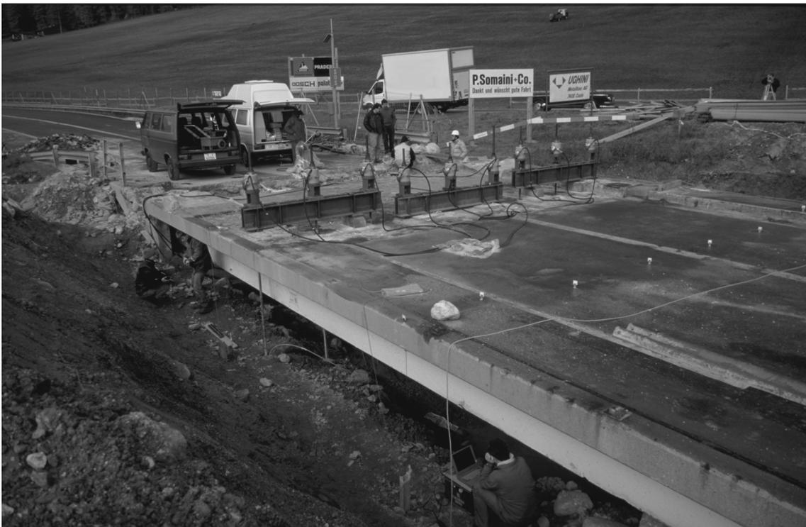
Bild 4.4 Übersicht des Belastungsversuches während der Durchführung der Messungen der Laststufe 6
