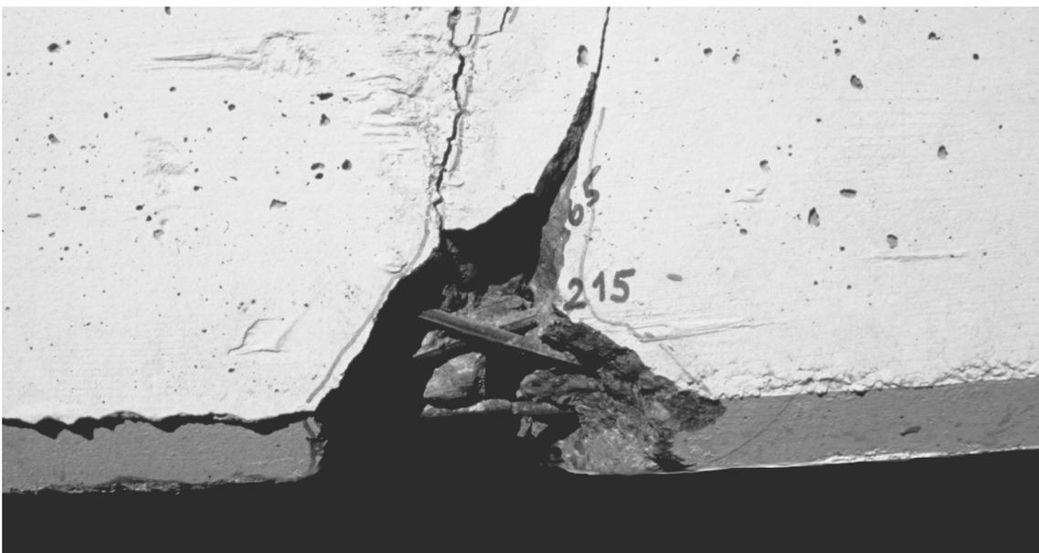
Bild 4.19 Details des Bruchbildes. Oben: Bruch der Bügel im Riss 4, unten: Bruch der Längsbewehrung im Riss 6
