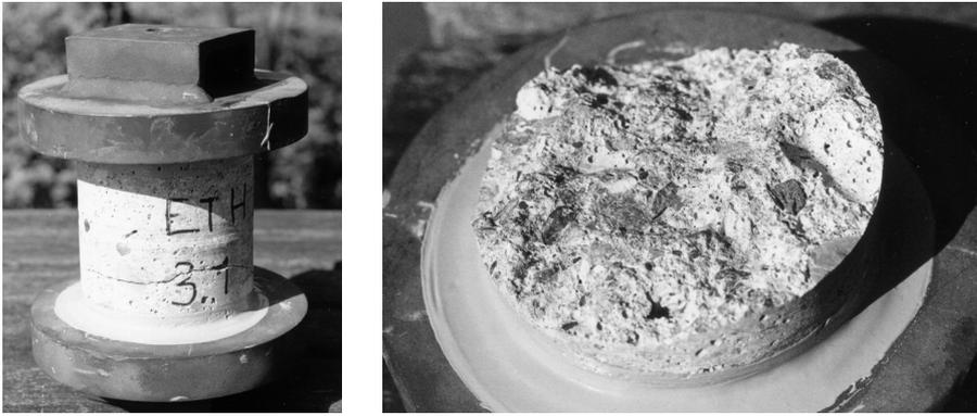
Bild 2.8 Bruchfläche eines Betonzylinders nach dem Zugversuch
