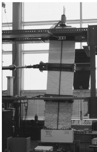
Bild 6.2: Wand WPH3, Schiefstellung bei Abbruch des Versuchs mit einem 400%-Erdbeben.
