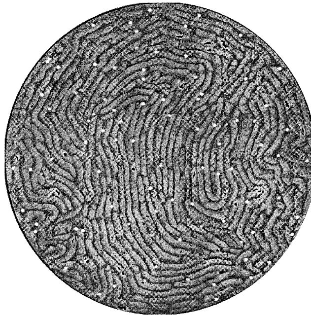
Figur 4.10: Schliffbild senkrecht zur Achse des Rohlings mit Durchmesser 6.9 mm für die V-OSP. Die ursprünglichen Prepreg-Bänder sind deutlich zu erkennen, ebenso wie die 50 µm Durchmesser W-Filamente (helle Punkte), die zwischen den Prepregbändern liegen. Die Anzahl der W-Filamenten beträgt 90 \pm 2 , was einen W-Filamentvolumenanteil von 0.5 % ergibt. Die Verteilung der W-Filament ist homogen. Die anhand von Dichtemessungen ermittelte Porosität liegt bei 1.8 %.
