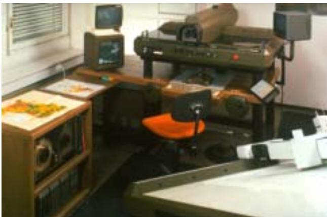
Abb. 8.1 analytisches Auswertegerät BC 2S von Leica digitale Photogrammetriestation DPW 770 von Helawa
