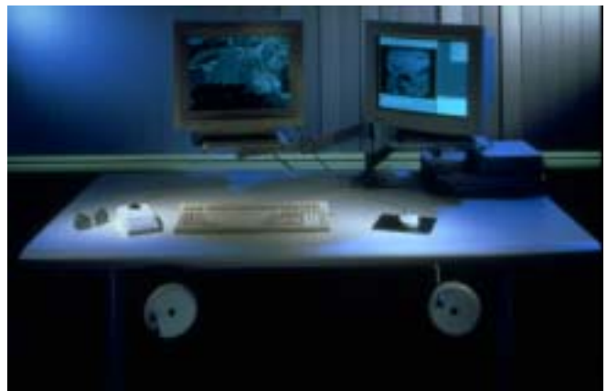
Abb. 8.1 analytisches Auswertegerät BC 2S von Leica digitale Photogrammetriestation DPW 770 von Helawa
