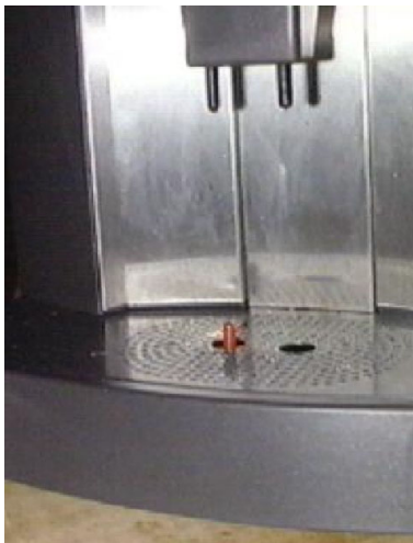
Bild (B917entZ) Wasserstandsfühler mittels Schwimmer unterhalb Tasse
