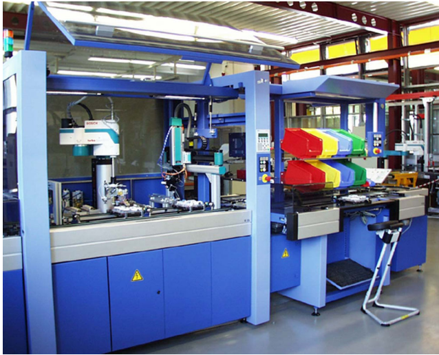
Bild (B101konZ) Modulares, hybrides Montagesystem auf der Basis vieler Zulieferkomponenten zur Fertigung eines Sicherungssockels (Quelle: http://www.faps.uni-erlangen.de/persons/LangStefan/TT-Zelle/TT-Zelle.htm )
