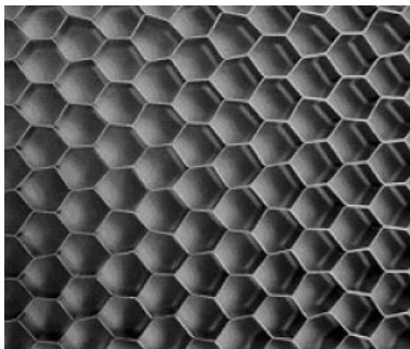
Bild (B115konZ) Belastungsstabile Leichtbaustruktur in Form von Bienenwaben
