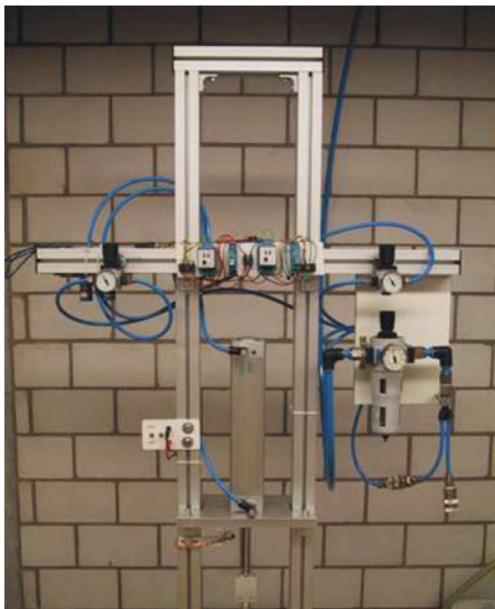
Bild (B024gesZ) Einfache pneumatische Testeinrichtung
