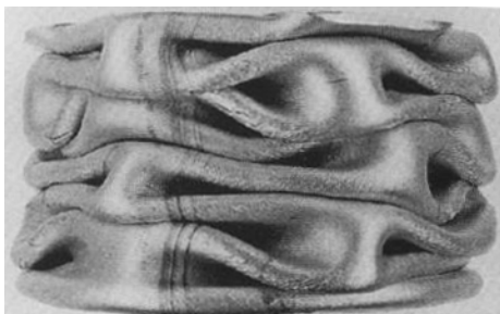
Bild (B205pipZ) Dünnwandiges Rohr, ausgebeult unter axialer Belastung
