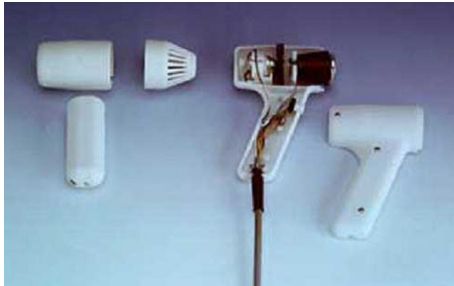
Bild (B909konz) Gehäuse-Prototyp aus Rapid-Prototyping-Verfahren um Funktion zu überprüfen
