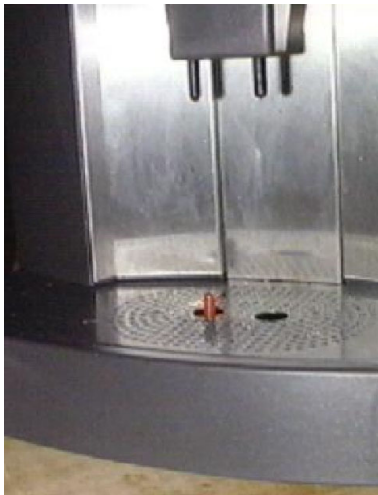
Bild (B917entZ) Wasserstandsfühler mittels Schwimmer unterhalb Tasse
