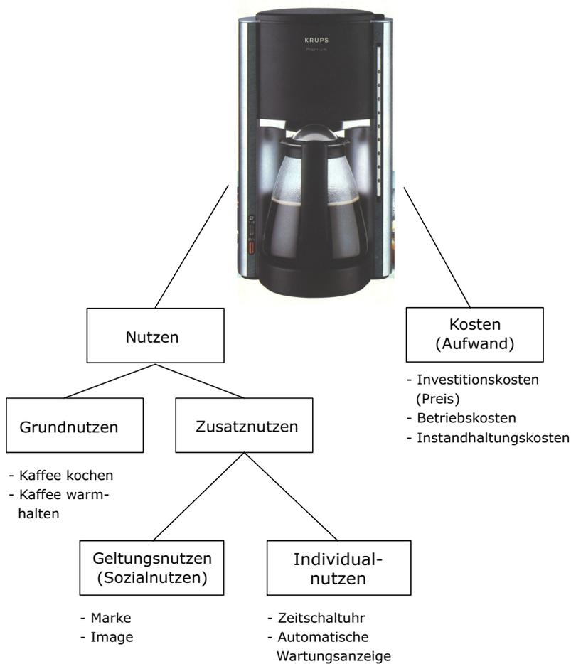
Bild (B853konD) Nutzen und Aufwände bei einer Kaffeemaschine
