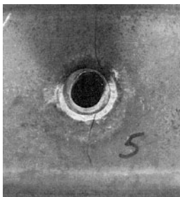
Bild (B306ermZ) Riss infolge zu grossen Spiels Führungsbuchse-Bolzen
