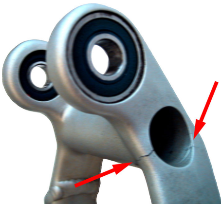
Bild (B816ermZ) Ermüdungsrisse an Bike-Schwinge
