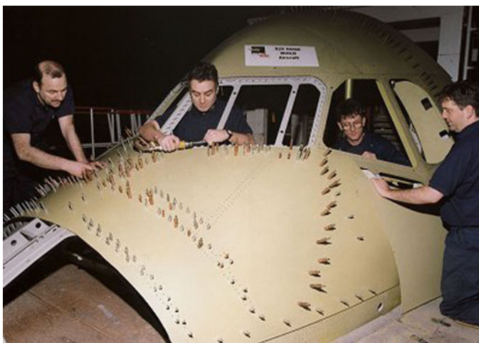
Bild (B201nivZ) Nieten im Flugzeugbau (Quelle: www.bae.regional.co.uk/44.html )
