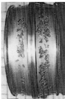
Bild (B014preZ) Defekte im Innenring eines Pendelrollenlagers
