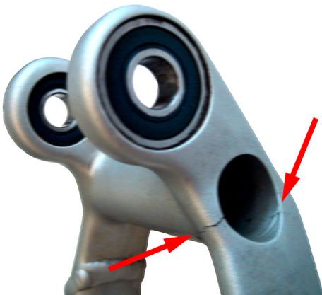
Bild (B816ermZ) Ermüdungsrisse an Bike-Schwinge
