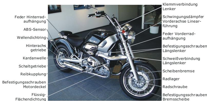
Bild (B001umeZ) Maschinenelemente am Motorrad
