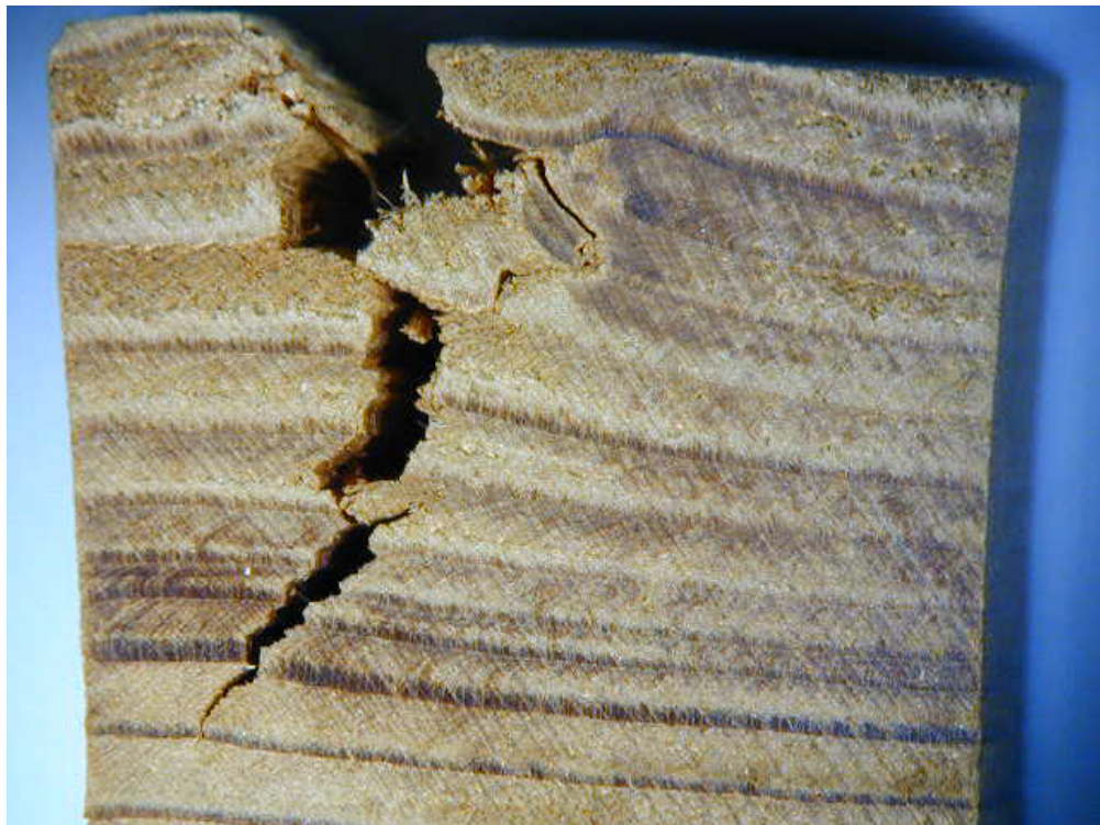
Abbildung 3-8: Trocknungsriß im Eschenholz
