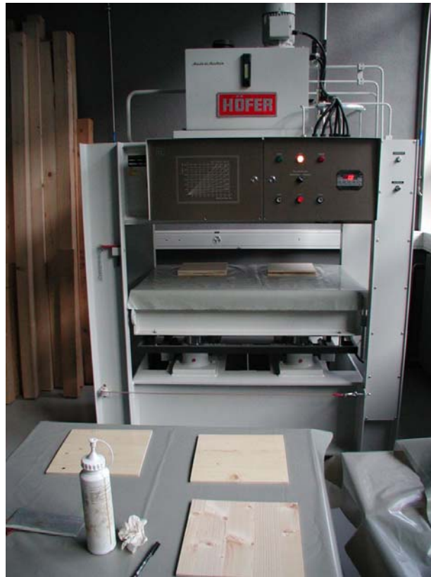
Abbildung 1: Presse zur Herstellung der Massivholzplatten mit zum Pressen vorbereiteten, beleimten Proben (im Hintergrund) sowie zum Verleimen einer Massivholzplatte bereitgelegten Lagen (im Vordergrund).
