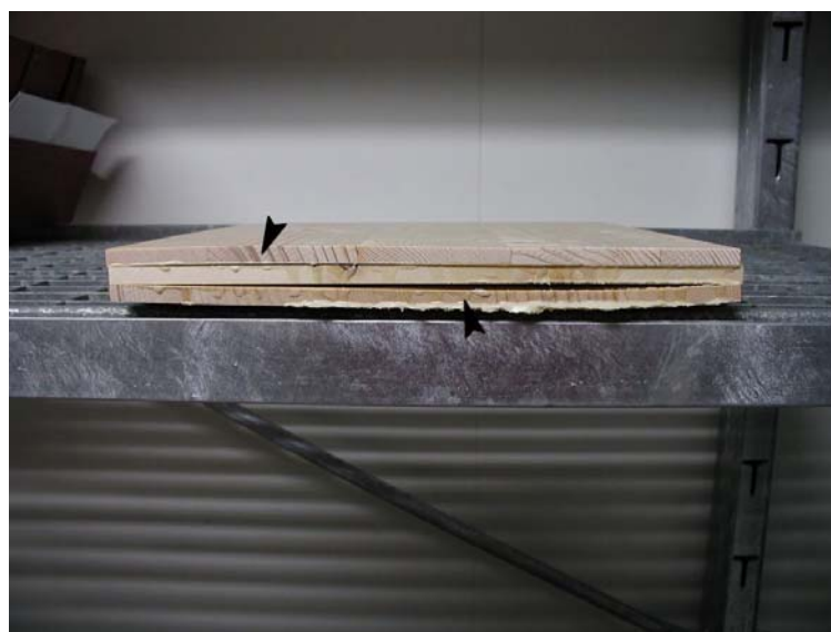
Abbildung 2: Teilweise Loslösung der Lagen voneinander beim ersten Pressversuch der Variante 1 (20°C/35% rLF).
