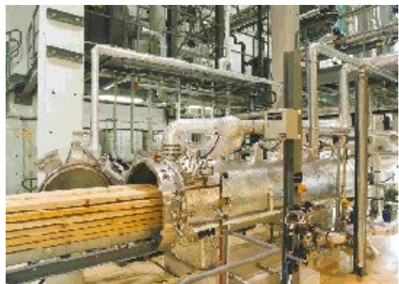
Abbildung 75 Acetylierungs-Anlage in der Industrie
