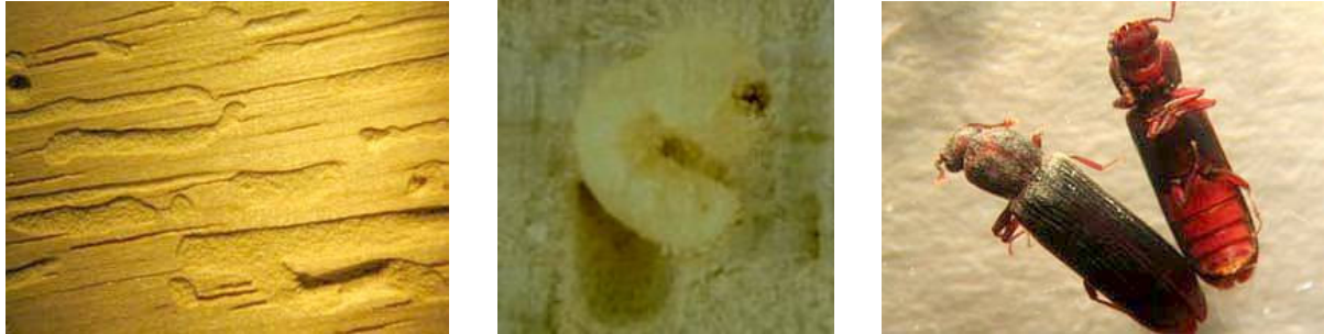
Abbildung 64 Frassgänge, Larve und Vollinsekt (Brauner Splintholzkäfer) (Quelle links und rechts: www.holzfragen.de ; Quelle mitte: www.pentol.ch )
