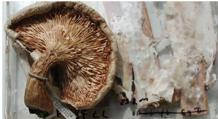
Abbildung 38 Fruchtkörper des Schuppigen Sägeblättlings und myzel-bewachsene Holzproben (Quelle: holzfragen.de)
