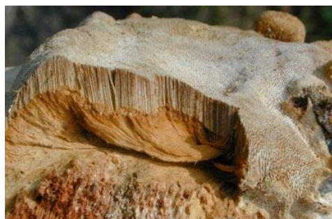
Abbildung 51 Fruchtkörper des Eichenporlings Abbildung 52 Myzel im Riegelanschluss eines Fachwerkbaus (Quelle: www.holzfragen.de ) (Quelle: www.holzfragen.de )
