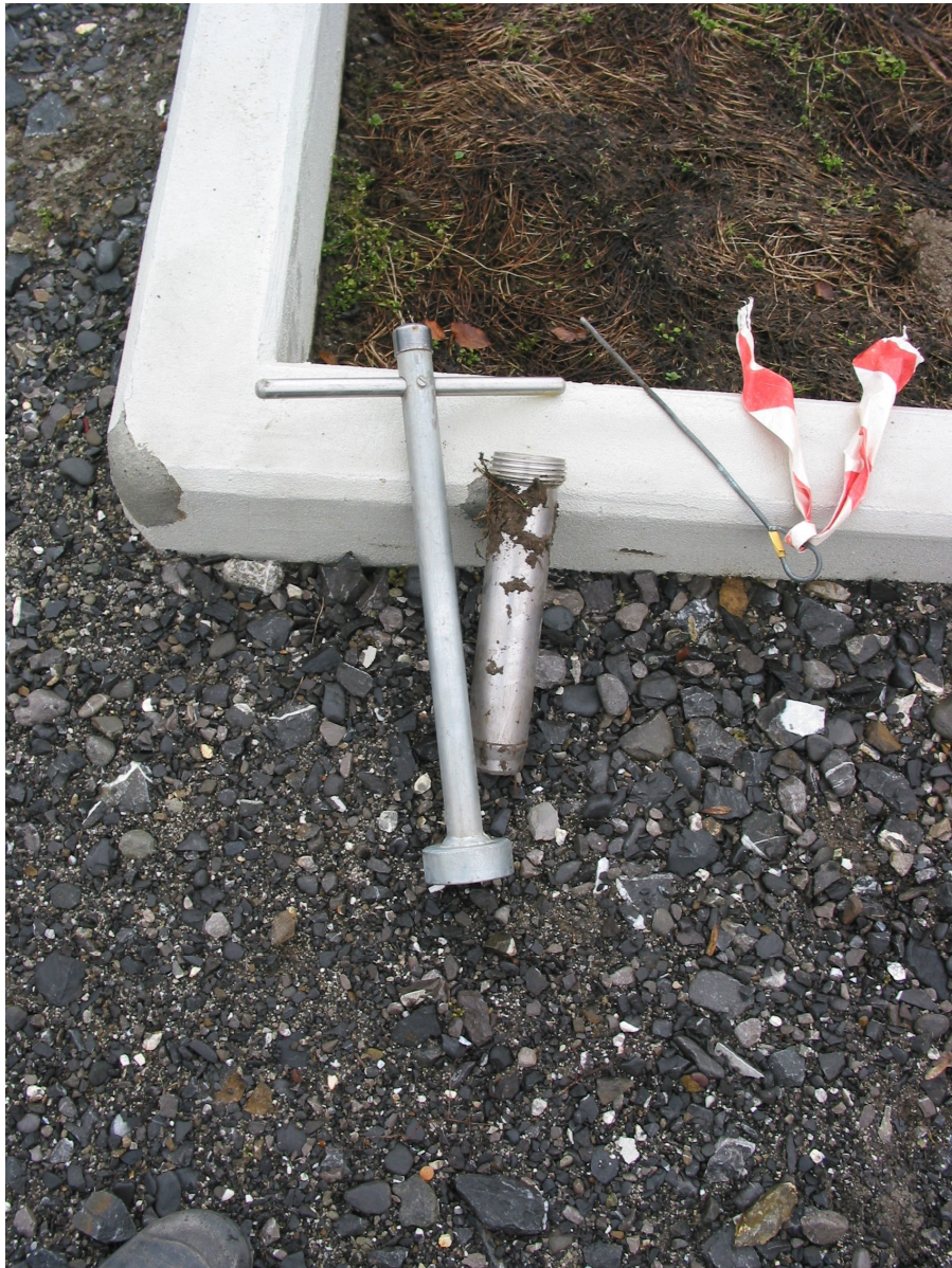
Abbildung 6: Mit dem Probennahmegerät konnte eine Probe von 5 cm Durchmesser und 30 bis 35 cm Länge entnommen werden.
