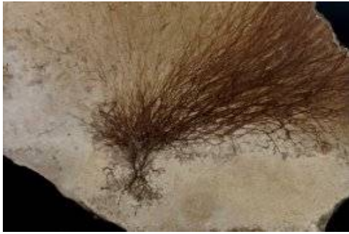
Abbildung 2.63 Myzel des Braunen Kellerschwammes (Quelle: www.pentol.ch)
