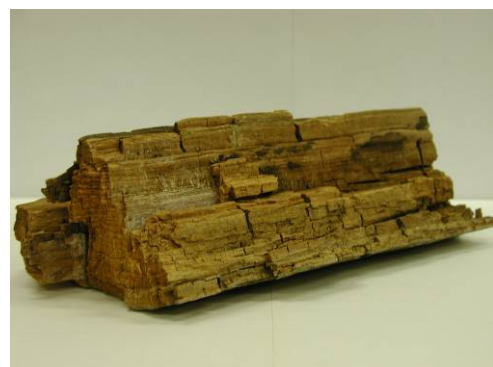
Abbildung 2.53 Braunfäule mit typischem
