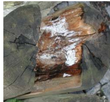
Abbildung 2.62 Schadbild und kleine Fruchtkörper (Quelle: www.holzfragen.de)
