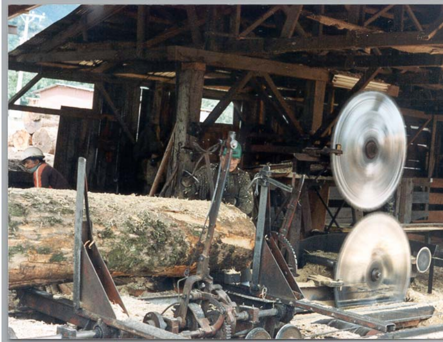
Abbildung 2.24: Kreissägemaschine zum Rundholzeinschnitt in Chile
