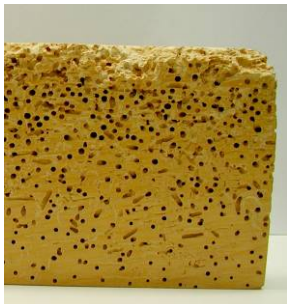
Abbildung 2.83 Schadbild, Larve und Vollinsekt mit Ausflugloch (Quelle mitte und rechts: www.pentol.ch )
