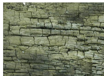
Abbildung 2.73 Dunkelfärbung und kleinteiliger Würfelbruch durch Moderfäulepilze
