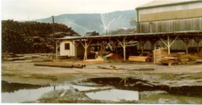
Abbildung 2.8: Besprühen von Rundholz zwecks Verhinderung von Bläue
