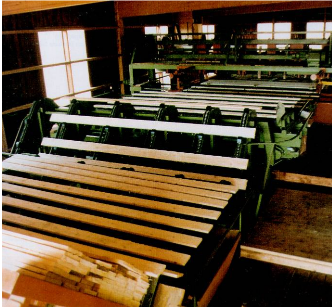
Abbildung 2.27: Stapelanlage, Fa. Balz, Langnau i.E./CH
