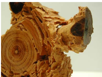
Abbildung 2.82 Frassgänge mit typischen Rippelmarken, Hausbockweibchen mit Ausflugloch, Larve (Quelle mitte und rechts: www.pentol.ch )
