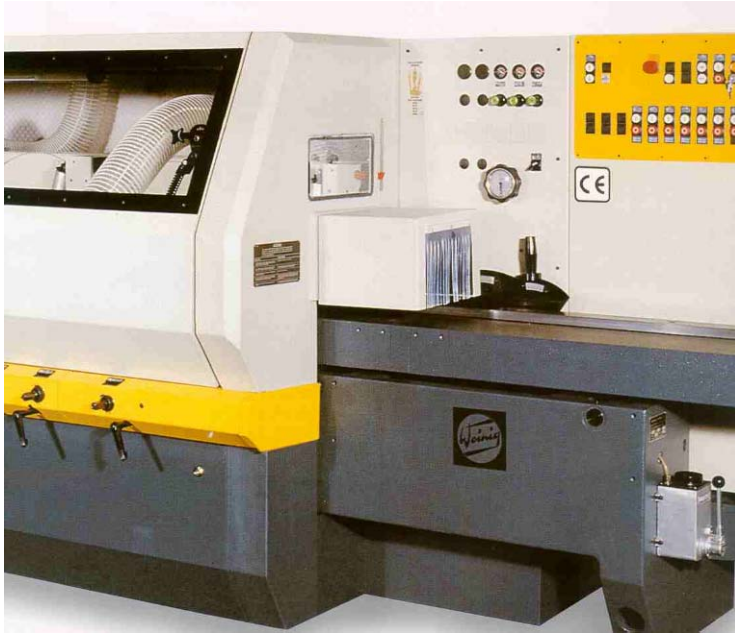
Abbildung 2.14: Vierseitenhobelmaschine zur Bearbeitung von Vollholz (Fa. Weinig)
