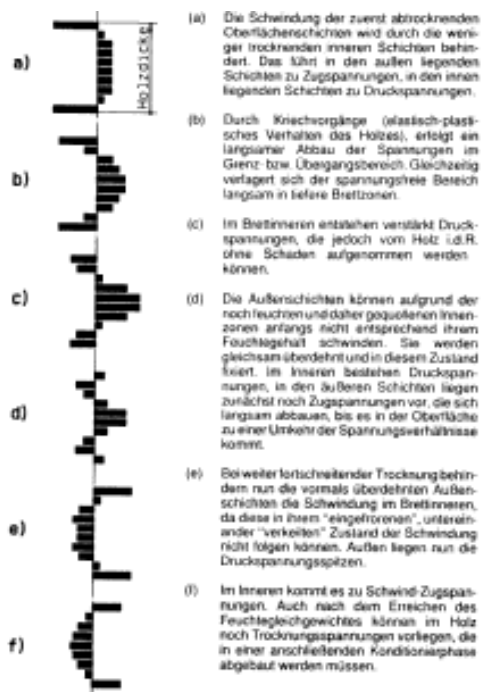
Abbildung 2.24: Feuchtegefälle über der Holzdicke bei der Trocknung in Abhängigkeit von der Zeit und der rel. Luftfeuchte
