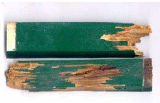
Abbildung 2.59 Schaden durch Blättlinge an Fensterholz
