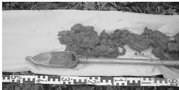
Abbildung 3-7: Handbohrgerät mit Probe im Bereich der Schichtgrenze zwischen siltigem und tonigem Sand
