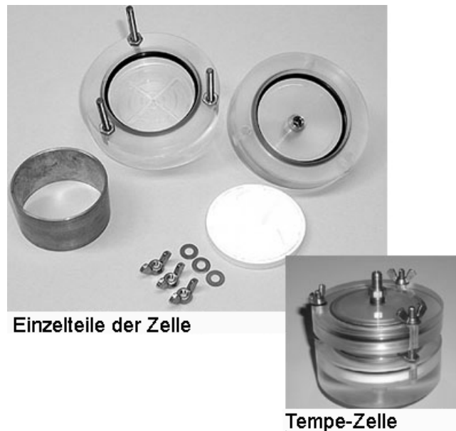
Abbildung 4-9: Tempe-Zelle (Bildquelle: www.soilmoisture.com )
