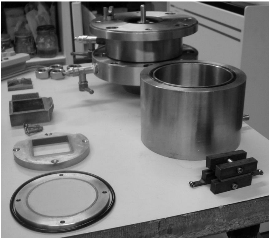
Abbildung 5-10: Einzelteile der demontierten Scherbox
