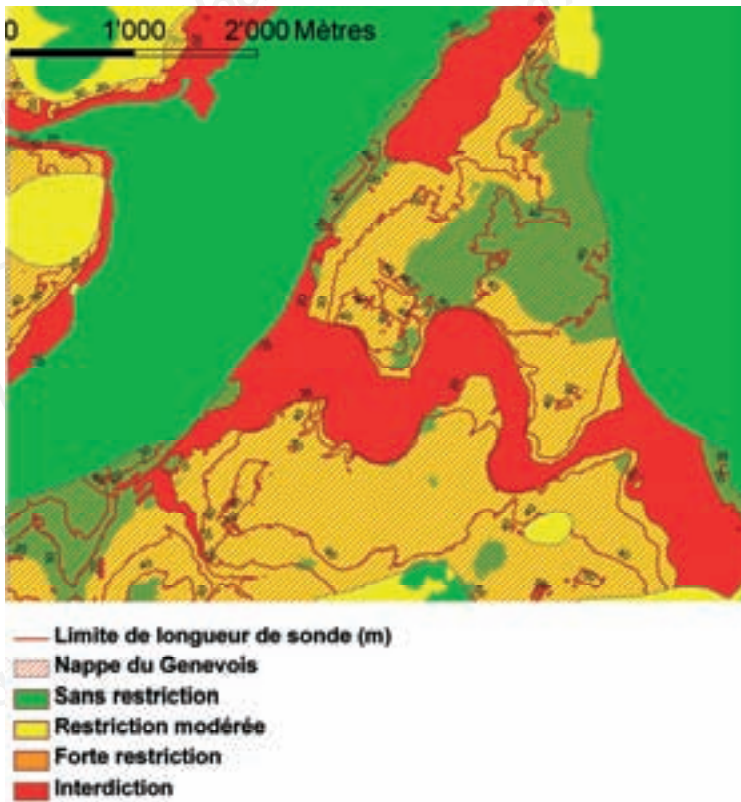
Figure 27 - Exemple de carte de restriction : sondes géothermiques
