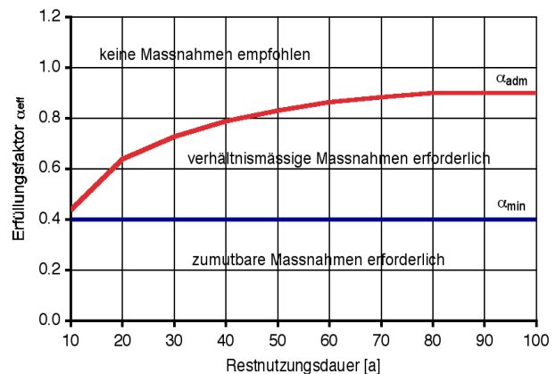
Abb. 5: Beurteilung der Erdbebensicherheit in Funktion des Erfüllungsfaktors und der Restnutzungsdauer bei Bauwerksklasse III (SIA 2018 2004)
