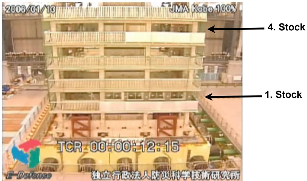
Simulation des Verhaltens eines Stahlbetonrahmengebäudes unter dem Kobe-Erdbeben auf dem weltweit grössten E-Defense-Rütteltisch im Hyogo Earthquake Engineering Research Center in Japan.
