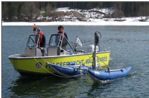
Figur 5: Boot und Seismic Katamaran
