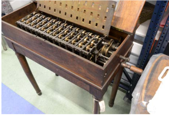
Mechanische Rechenmaschine aus dem 19. Jahrhundert mit 36 Ziffernrädern und Kurbel
