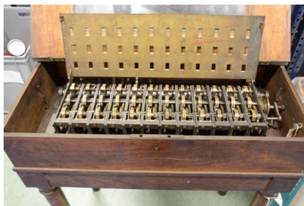
Mechanische Rechenmaschine von Jean-Baptiste Schwilgué mit 36 Ziffernrädern aus Messing
