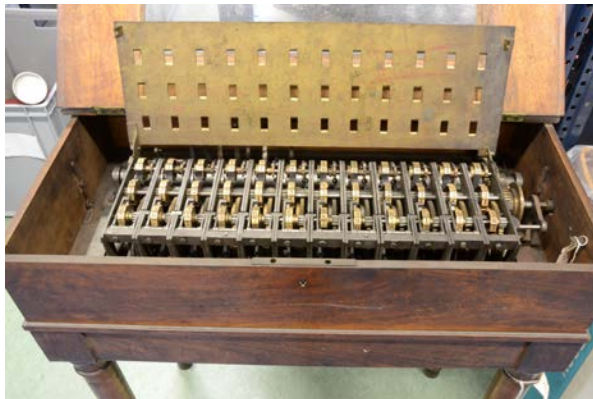
Abbildung 2: Schwilgués mechanische Addiermaschine (um 1840) mit 36 Ziffernrädern aus Messing, © Historisches Museum, Straßburg, 9. Dezember 2014
