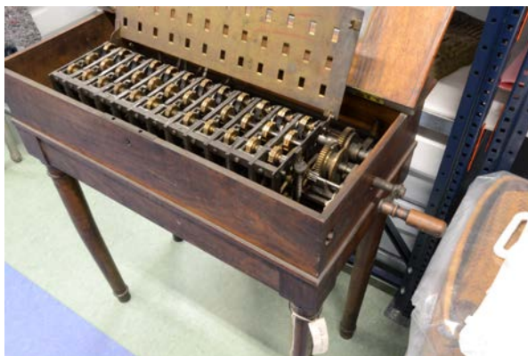
Abbildung 3: Schwilgués mechanische Addiermaschine (um 1840) mit 36 Ziffernrädern und Kurbelantrieb, © Historisches Museum, Straßburg, 9. Dezember 2014
