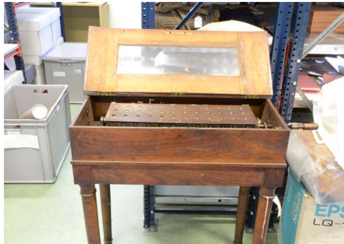
Abbildung 4: Additionsmaschine im Straßburger Museumsdepot mit geöffnetem Decker, Blick auf die 36 Schaulöcher, © Historisches Museum, Straßburg, 9. Dezember 2014
