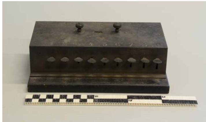
Abbildung 5: Das älteste und kleinste Versuchsmodell A des Tastenaddierers wurde wohl schon vor 1844 (Patentierung) angefertigt. Es hat keine Herkunftsbezeichnung, kann aber wegen der übereinstimmenden Bauart eindeutig Schwilgué zugeordnet werden. Das „Wellblech“ fehlt, die Ziffern sind oben auf dem Gehäuse angeordnet. © Historisches Museum, Straßburg, 9. Dezember 2014
