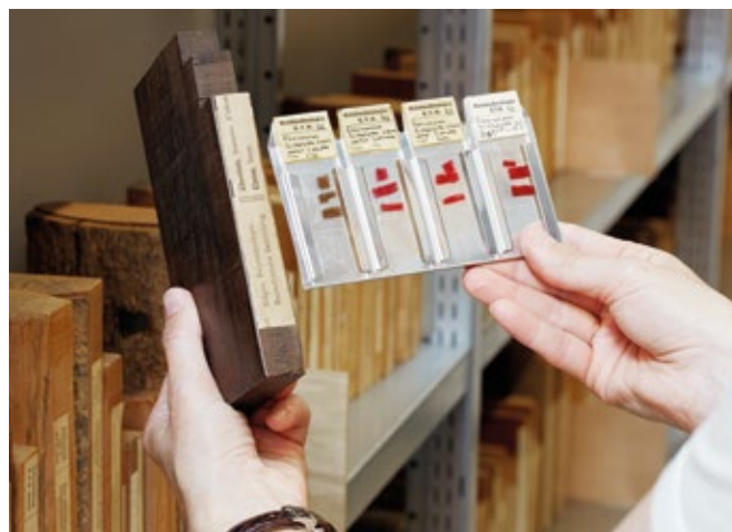
Die Xylotheke an der Professur Holz-basierte Materialien umfasst Handstücke und Mikropräparate von Holzarten aus der ganzen Welt, darunter auch sehr seltene Objekte wie diese Ebenholzprobe. 2014. ETH-Bibliothek Zürich/Frank Blaser.
