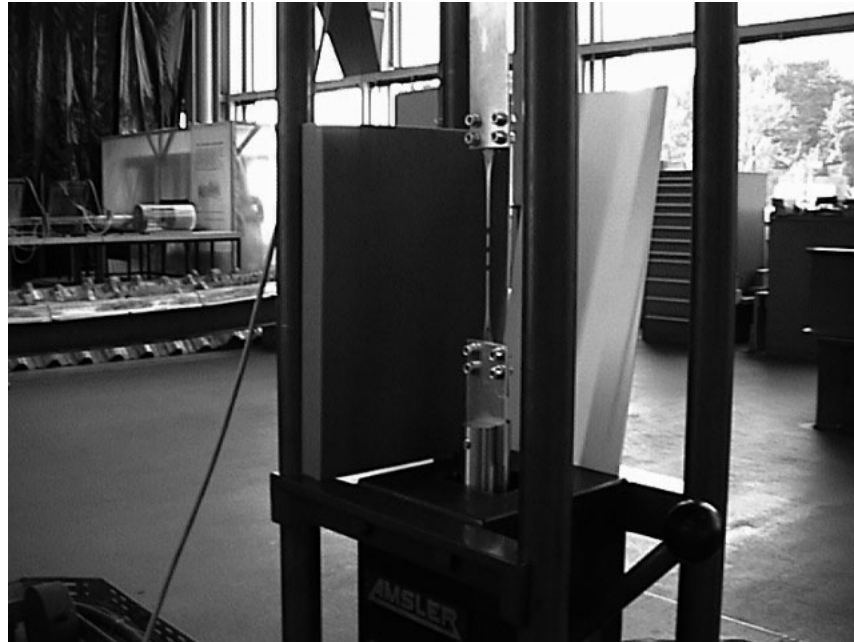
Bild 2.6 Versuchseinrichtung für die Zug-Kriechversuche.
