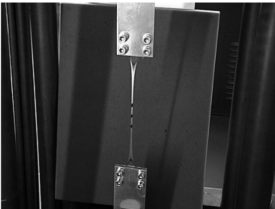
Bild 2.7 Zugversuche; (a) irreversible Verformungen in Form von weisser Trübung des Materials, (b) Bruch des Versuchskörpers im schmalen Bereich.
