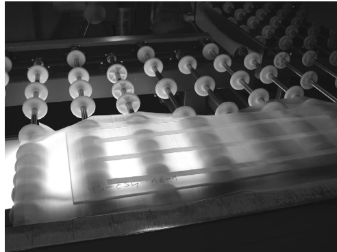
Bild 3.2 Herstellung der VSG-Scheibe mit GFK-Einlagen (Glas-Faser-Kunststoff).
