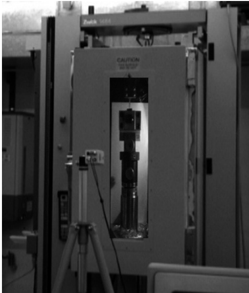
Bild 2.4 Versuchseinrichtung für die Zugversuche; (a) Prüfmaschine mit Klimakammer und Videoextensometer; (b) durch die Klemmvorrichtung eingespannter Versuchskörper.
