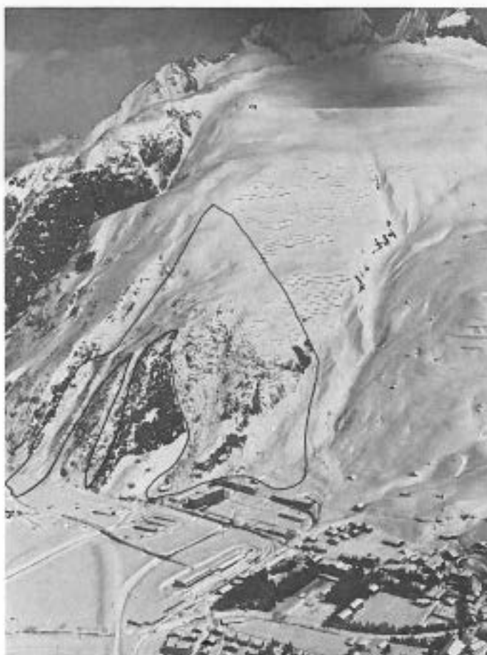
Fig. 5 Kirchberg/Andermatt, Kanton Uri: Lawine vom 6. April 1975 mit Anbruchgebiet links der permanenten Stützverbauung und mit Sturzbahnen über verbaute und aufgeforstete Hänge. (Flugaufnahme E. Wengi, EISLF)
