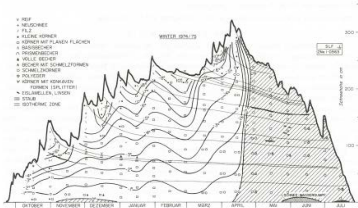
Fig. 6 Kornformentwicklung und Temperaturverlauf im Versuchsfeld Weißfluhjoch 1974/75
