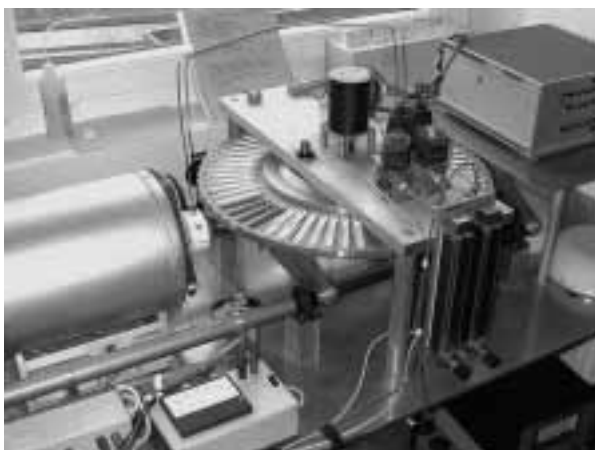
Abbildung 1: Der POC-Automat, der 1981 von der EAWAG-Werkstatt gebaut wurde und bis heute fast täglich in Betrieb steht. Links der Ofen, in der Mitte der automatisierte Probenwechsler, rechts die Steuerelektronik für die Schrittmotoren. (Foto: Andreas Frutiger)
