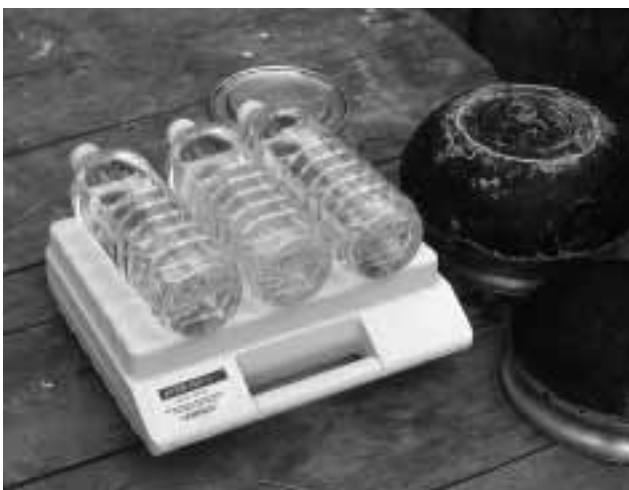
Abbildung 1: Abgesetzte Fe(III)(hydr)oxide in horizontal liegenden PET-Flaschen nach eintägiger Belichtung. (Foto: Daniel Gechter)
