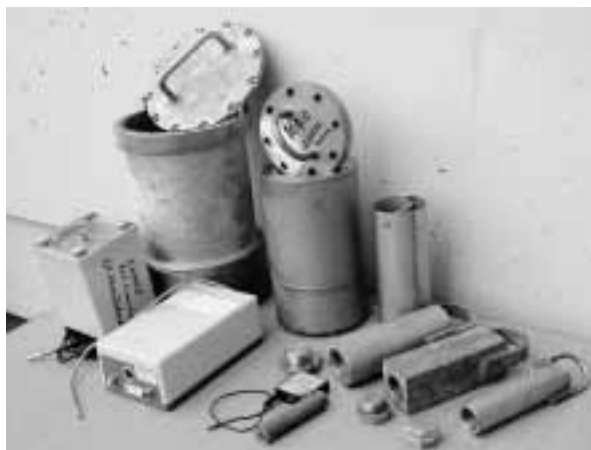
Abbildung 2: Seit 1980 wurden die Feld-Temperaturmessgeräte immer kleiner. Für jede neue Gerätegeneration wurde von der Werkstatt ein dazu passender Gehäusotyp gebaut. (Foto: Andreas Frutiger)
