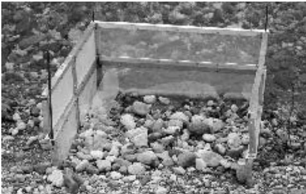
**Abbildung 1: Netzrahmenkonstruktion zur Abgrenzung des Eintrages von Organismen aus dem aquatischen Lebensraum.**
