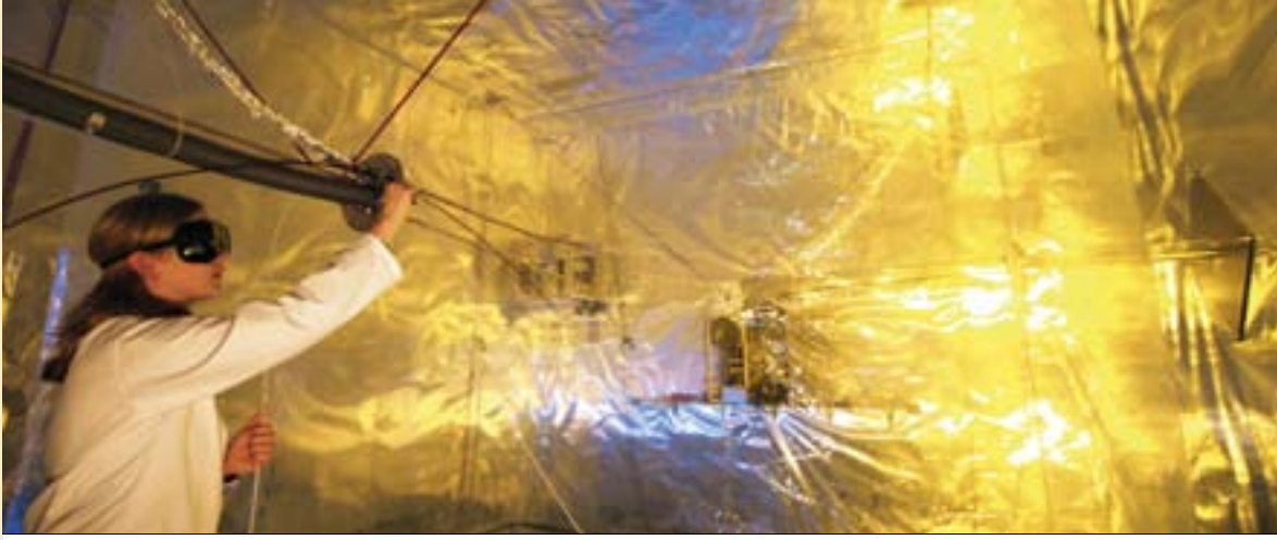
In der Smogkammer lassen sich chemische Untersuchungen der (simulierten) Atmosphäre durchführen.
