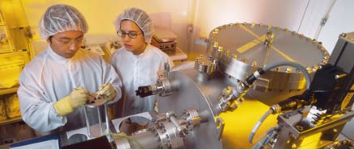
Nanostrukturen mit Fotolithografie an der Röntgen-Interferenz-Lithografie (XIL)-Strahllinie der SLS.
