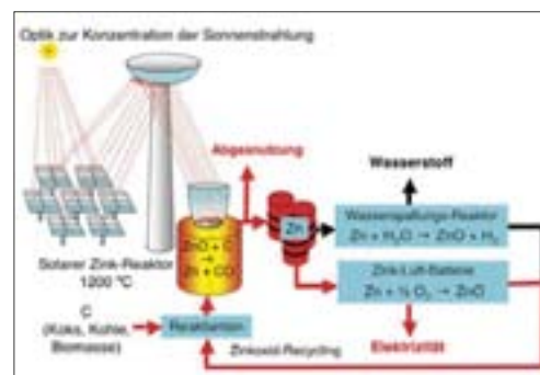
Geschlossener Materialkreislauf: Die solare Zinkherstellung im Zink-Zinkoxid-Kreisprozess liefert Solarstrom oder auch solaren Wasserstoff.
