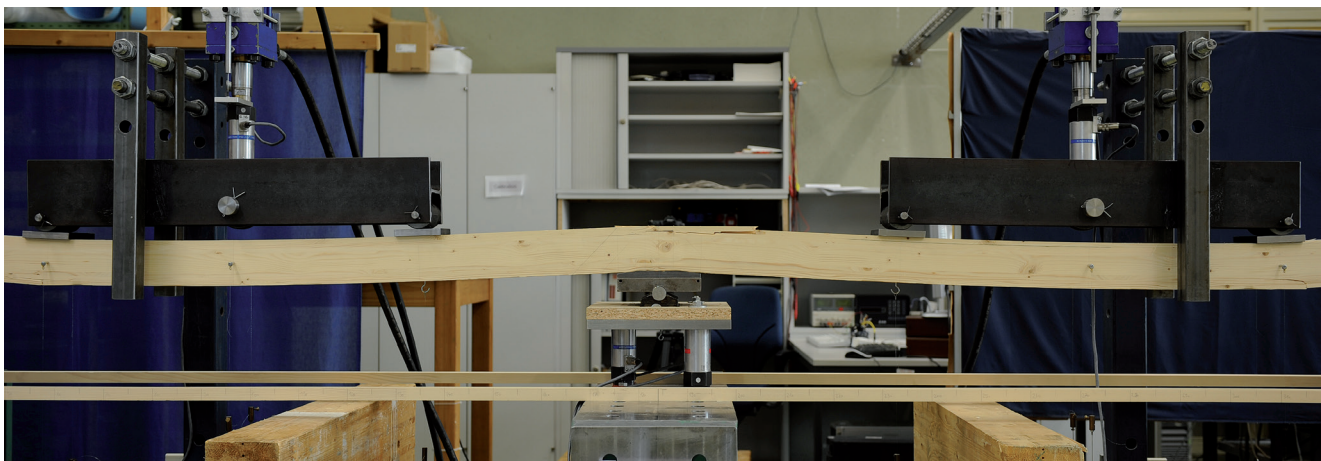
Plastische Gelenke in BSH mit Fasereinlagen. Plastic hinges in GLT with fiber inlays.
