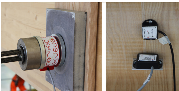
Fig. 1: Kraftmessdose zur Langzeitüberwachung der Spannkraft und Beschleunigungssensor zur periodischen Schwingungsmessung. Load cell for the long-term monitoring of post-tension force and acceleration sensor for ambient vibration testing.
