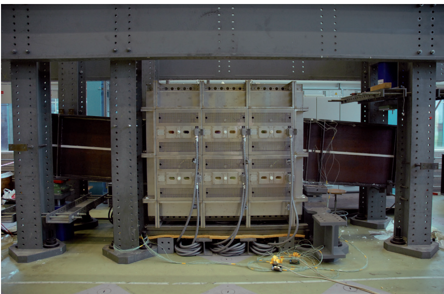
Modularer elektrischer Ofen mit eingebautem Blechträger. Steel plate girder inside of the modular electric furnace.
