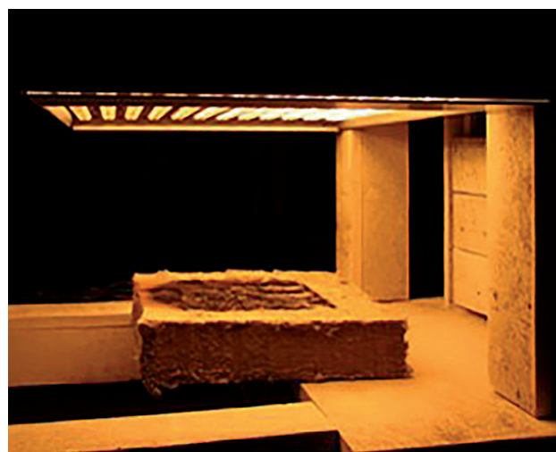
Holz unter einem Wärmestrahler. Timber specimen under a radiant heat panel.
