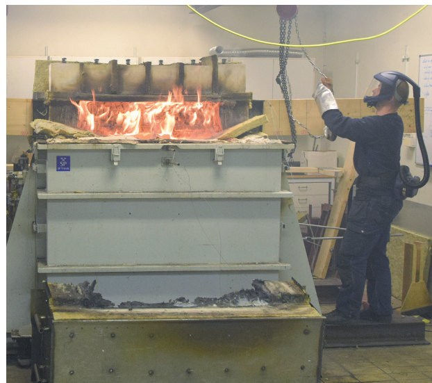
Ausbau der Probekörper nach dem Brandversuch. Dismantling after testing.
