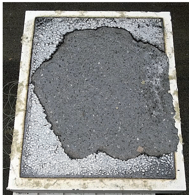
Abplatzen von HPC Platte mit Anstrich nach 99 min ISO-Brandeinwirkung.
