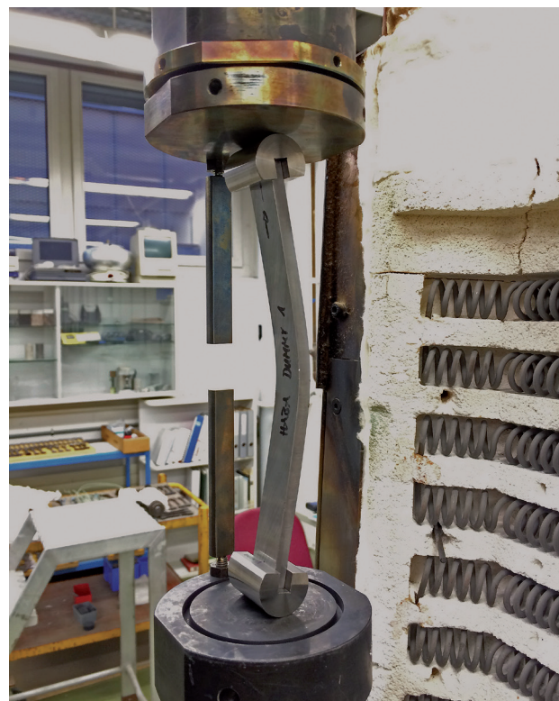
Versuchseinrichtung für temperaturabhängige Knickversuche. Test setup for temperature-dependent buckling tests.
