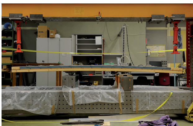
HBV-Träger überhöht durch expansiven Mörtel. TCC slab cambered by the use of expansive mortar.
