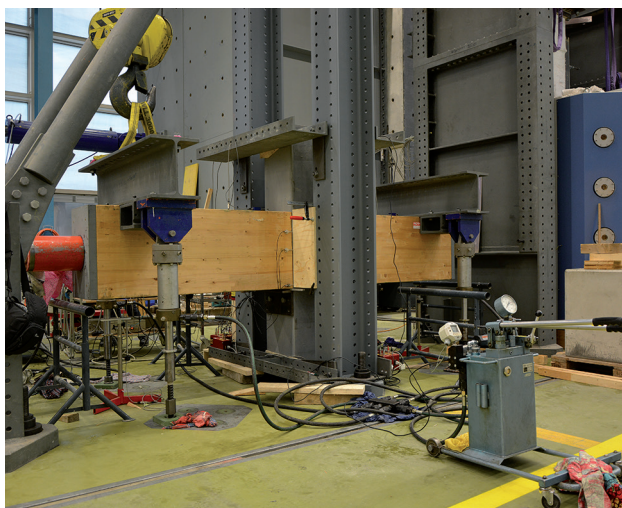
Biege-Versuche an einem vorgespannten Knoten mit Betonstütze. Tests on a post-tensioned joint with concrete column.
