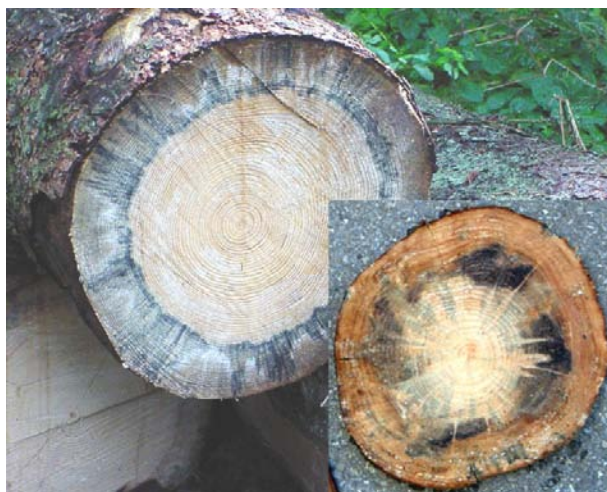
Fig. 16: Coloration du bois d'épicéa suite à une infestation par des champignons du bleuissement (grande photo), et à l'emmagasinage de fer (petite photo).
