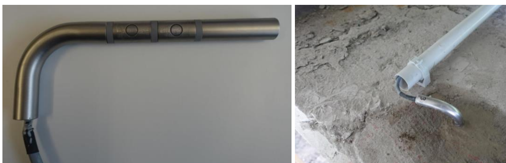
Abb. 14 In Bauwerk eingebaute Makroelementstrom-Messzelle. Links: vor dem Einbau. Rechts: nach dem Einbau in den Querträger (mit Kunststoffrohr zum Schutz des Kabels).
