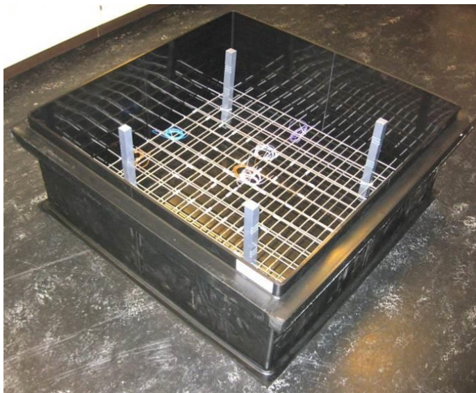
Abb. 8 Becken 1 m x 1 m x 0.4 m mit Bewehrungsgittern aus nichtrostendem Stahl zur Durchführung der Versuche in wässriger Lösung [13].
