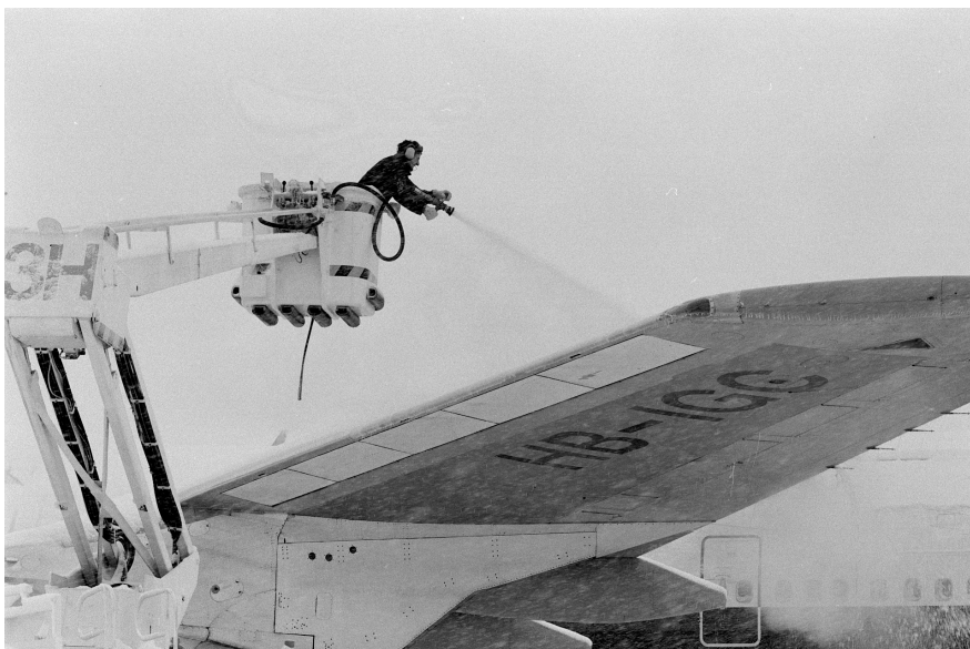
Abb. 3: Tage mit viel Schnee und extremer Kälte in Zürich-Kloten: Enteisung der Boeing 747-357 Combi, HB-IGC »Bern«, 1985.
